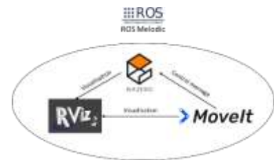
Figure 2 Structure de l'environnement simulation
